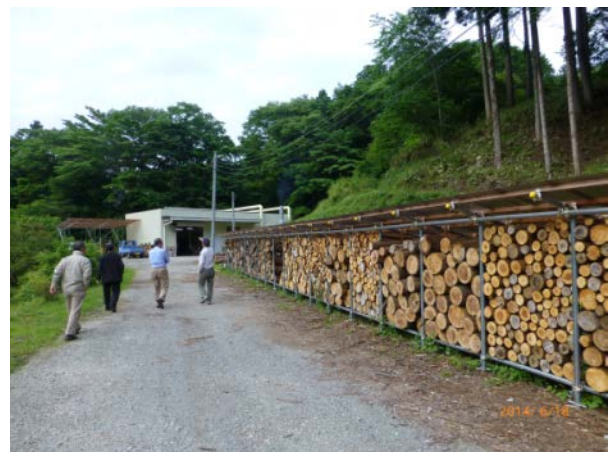
ボイラー室近くの燃料置き場
