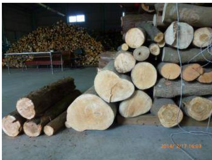
写真6 投入可能な丸太直径は200mm（右は雑木）
