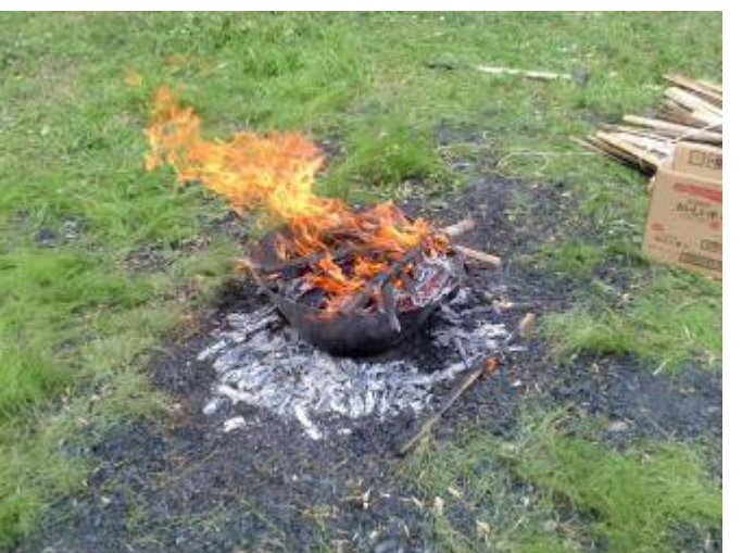
写真18 無煙炭化器による燃焼テスト
