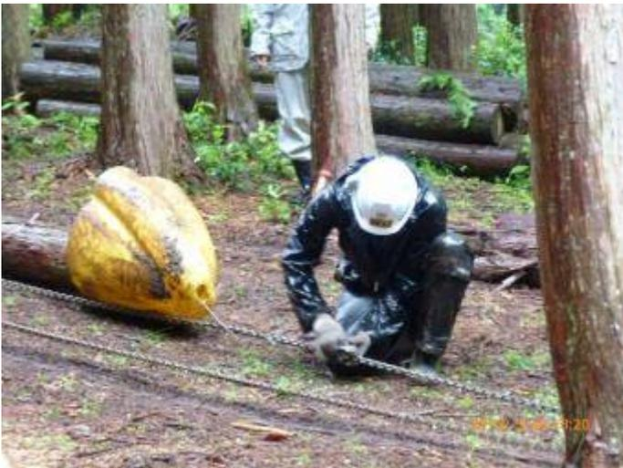
写真19 下に到着した材料をチェーンから取り外す
