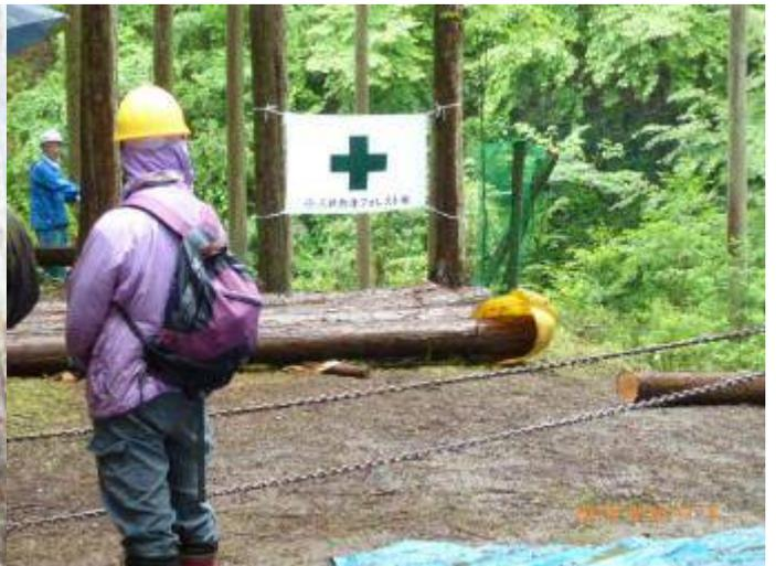
写真20 左サイドの集積場までポートウインチで引っ張り込む
