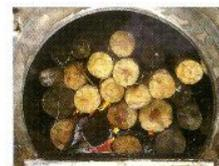
一次燃焼炉に間伐材等の木材を投入すると、熱分解により発生した可燃ガスは下部にある二次燃焼炉に流れて行きます。二次燃焼炉では燃焼温度は約1000度まで上昇しガスを燃焼するので排煙を最小限に抑えることができます。また、木材はほぼ燃え尽きるため残灰は極端に少ないです。
