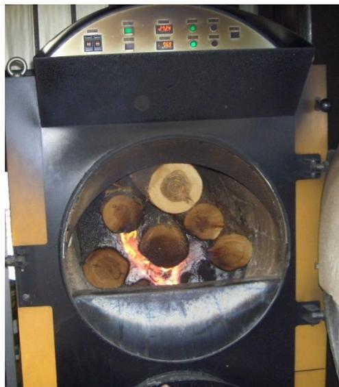
写真-1 一次燃焼炉、燃料投入口
