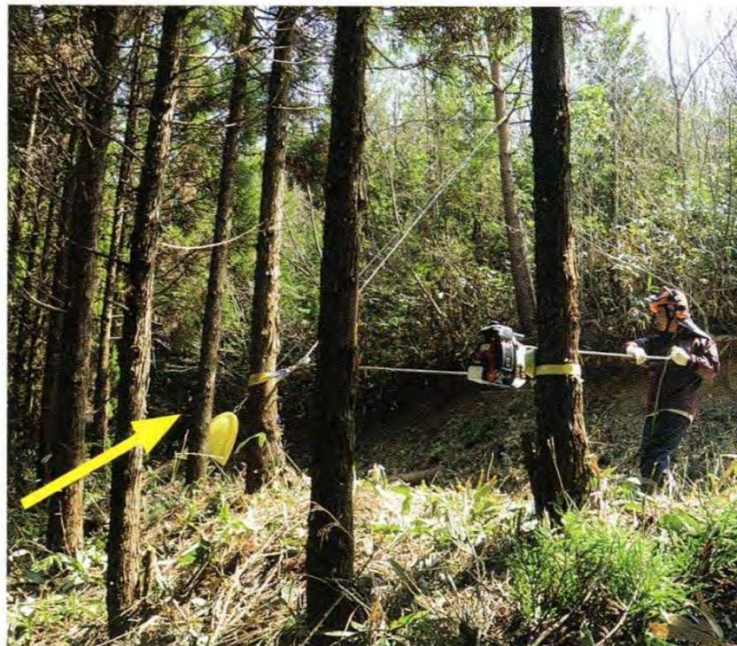
◀▲ロープウインチに巻き付けたロープを軽く手繰るだけで、材が引き上げられていきます
