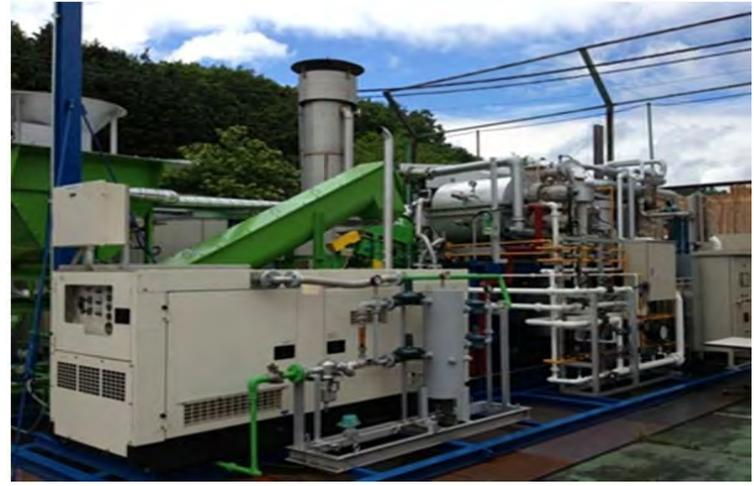
小型超高温水蒸気式ガス化発電装置
